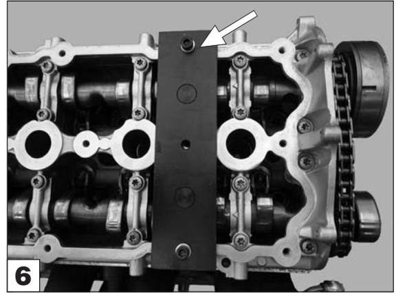
Setzen Sie die HAZET 2588-23 Nockenwellen-Fixierung ein und verschrauben diese auf dem Zylinderkopf
