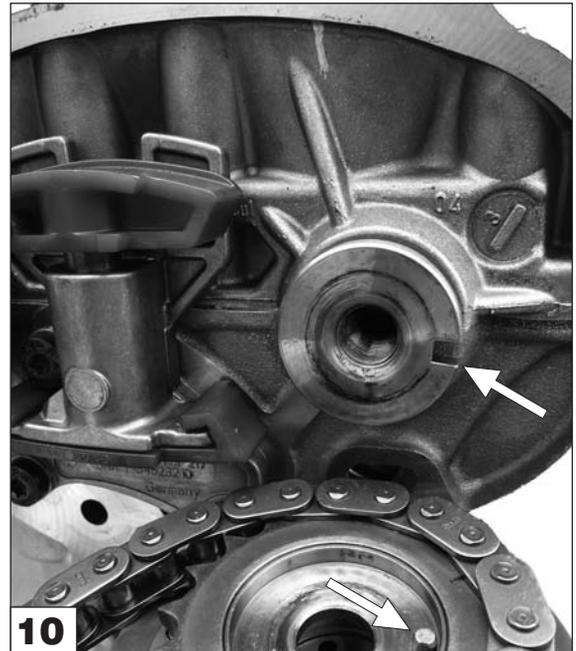
Legen Sie die Kette auf die variable Steuerungseinheit [VVT] und dann auf das Einlassnockenwellenrad auf. Vergewissern Sie sich, dass der Stift der Auslassnockenwelle und die Keilnut der variablen Steuerungseinheit [VVT] übereinstimmen.
