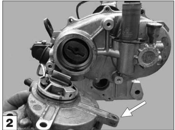
Entfernen Sie die Vakuumpumpe.
