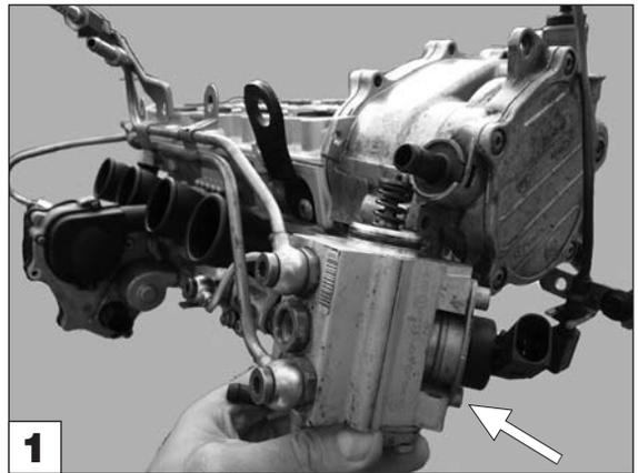
Entfernen Sie die Hochdruckkraftstoffpumpe und verschliessen Sie alle Öffnungen des Kraftstoffsystems, um Schmutzeintritt zu verhindern.
