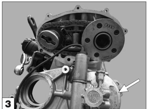
Entfernen Sie das Nockenwellenversteller-Gehäuse.
