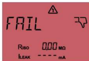
Abb. 31: Nicht bestandene Isolationsprüfung
