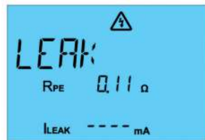
Abb. 59: Schutzleiterstrommessung bei einem 3-Phasen-Gerät
