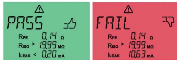
Abb. 24: Bestandene Schutzleiterstrommessung (links) und nicht bestandene Schutzleiterstrommessung (rechts)
