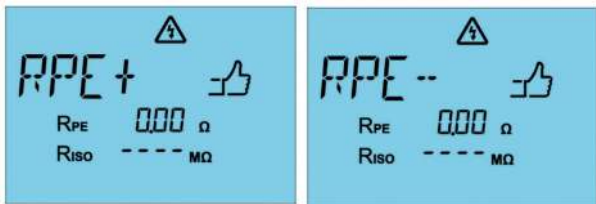
Abb. 56: R_{PE+} → positive Stromrichtung (links) und R_{PE-} → negative Stromrichtung (rechts)
