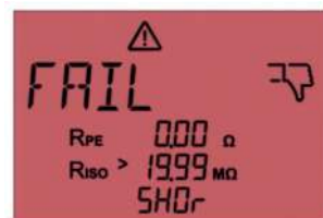
Abb. 48: Nicht bestandene Messung. Im Display wird „SHOr“ angezeigt. Kurzschluss zwischen L und N
