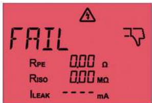
Abb. 22: Nicht bestandene Isolationsprüfung
