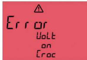
Abb. 61: Spannung auf Metallteilen des Prüflings
