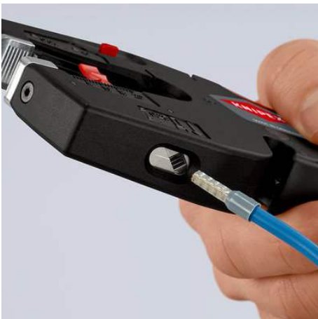
Vierkant-Crimpstelle für Aderendhülsen 0,25 - 4 mm 2 / bis 2x2,5mm 2 .
