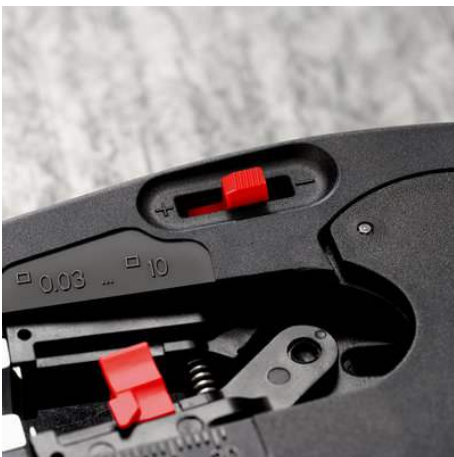
Die Feinjustierung ermöglicht zuverlässiges Abisolieren auch bei besonderen Einsatzbedingungen (spezielle Isoliermaterialien oder extreme Temperaturen)
