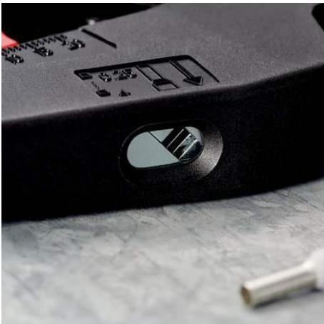
Vierkant-Crimpstelle für Aderendhülsen 0,25 - 4 mm 2 / bis 2x2,5mm 2 .
