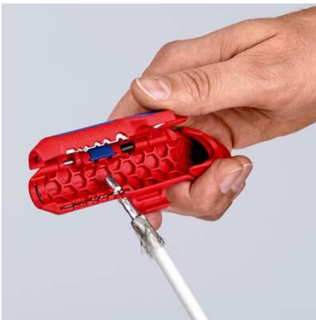
Abisolieren eines Koaxialkabels
