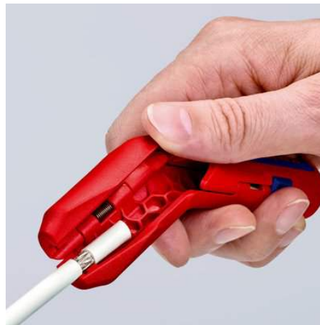
Abmanteln eines Koaxialkabels
