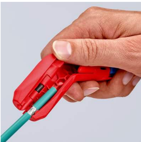
Abmanteln eines Datenkabels
