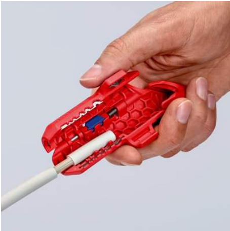
Abmanteln eines NYM-Kabels
