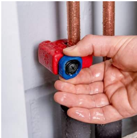
Minimierter Schneidkreis zum Trennen von Rohren auf engstem Raum
