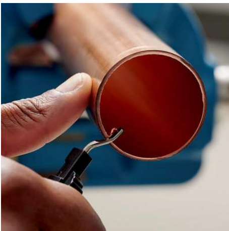
Das präzise geschliffene Entgratungswerkzeug kann bei Bedarf aus dem Werkzeug genommen werden
