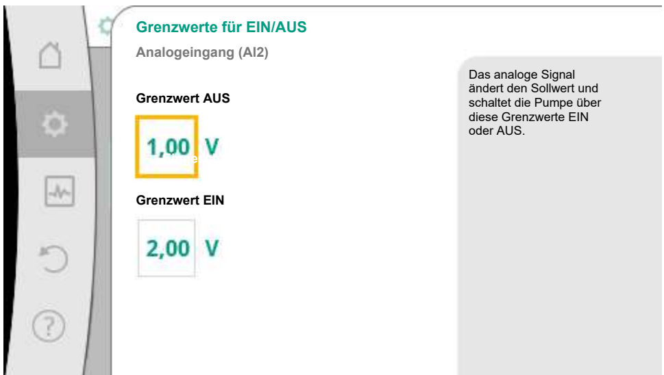
Fig. 74: Grenzwerte zur EIN/AUS-Steuerung über Analogsignale
