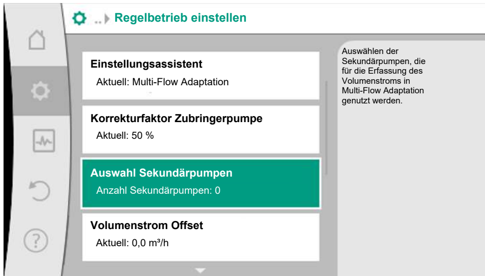
Fig. 51: Auswahl der Sekundärpumpen zu Multi-Flow Adaptation
